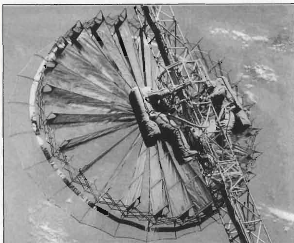
Figura 6: esperimento di apertura di un riflettore "ad ombrello" a bordo della MIR
